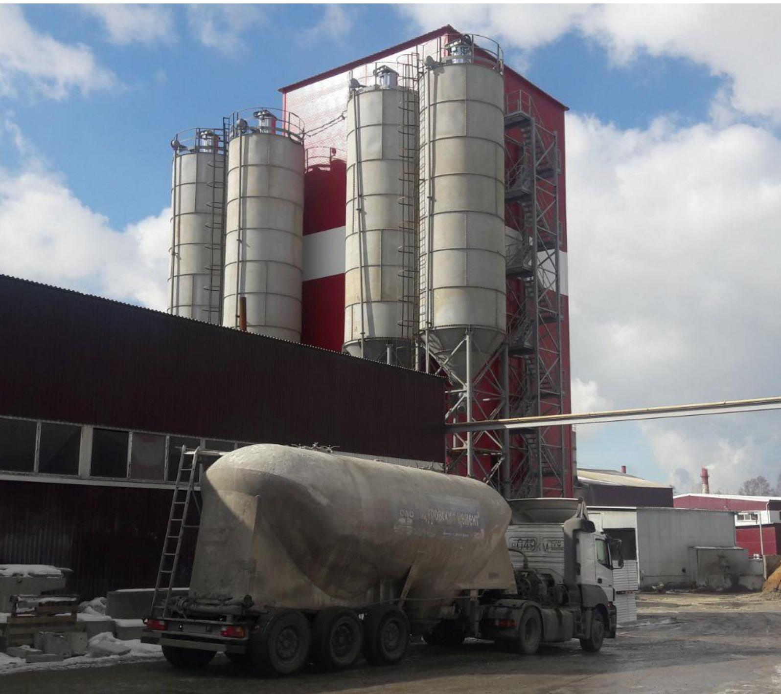
Стационарное оборудование башенного типа большей производительности **ARCENAL** предназначено для производства кладочного раствора, товарного бетона и других видов бетонных смесей, в том числе для изготовления железобетонных изделий.
