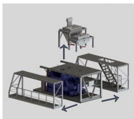
Демонтаж модуля смесителя для транспортирования
